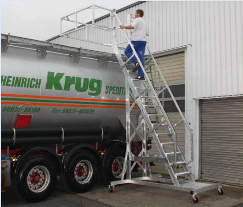
Tankwagenleiter fahrbar mit beidseitigem Geländer und einem Schutzkorb
