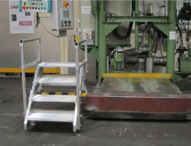
Arbeitspodest, mobil, an der Maschine geführt
