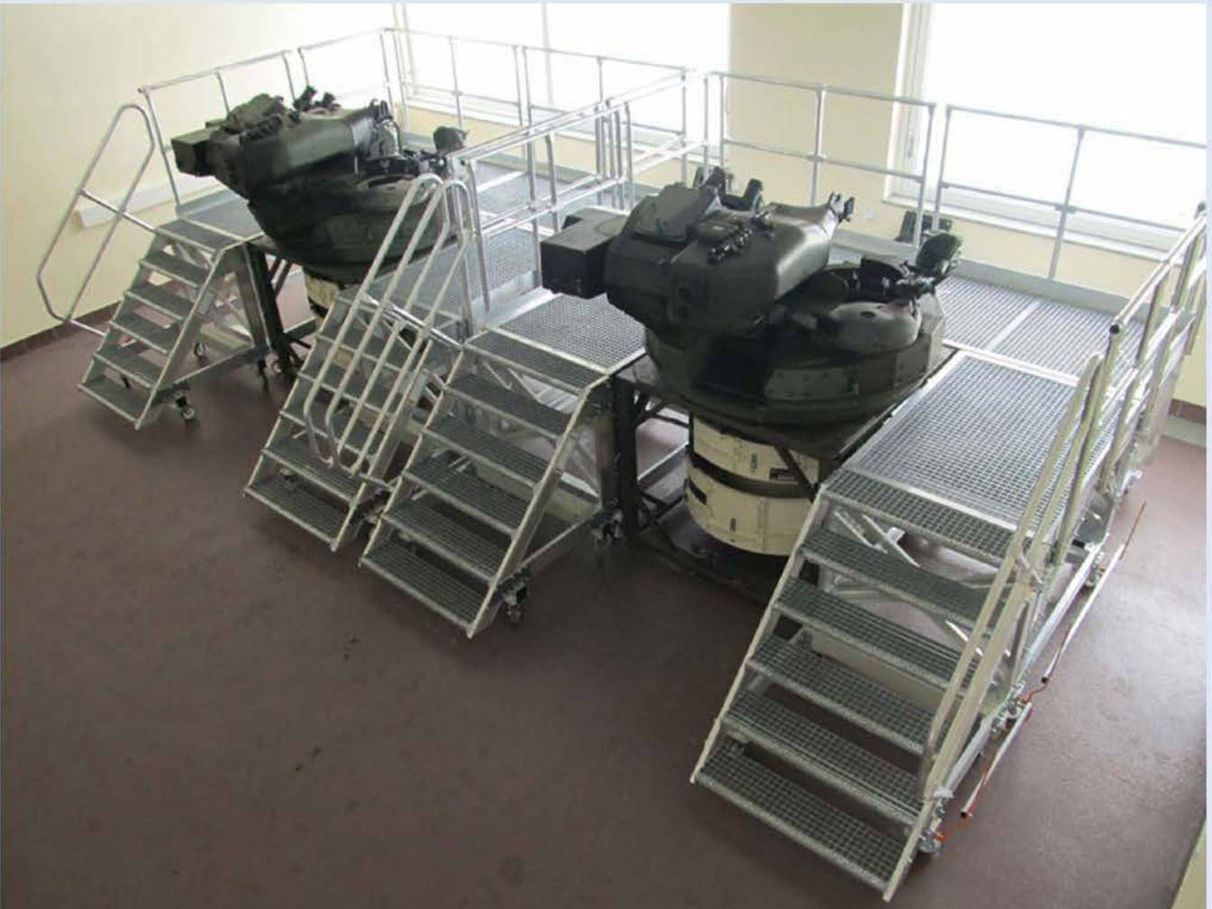
Montageplattform, fahrbare Ausführung mit Zentralbremse, 6 Einzelteile - alle miteinander über Spannverschlüsse verbunden
