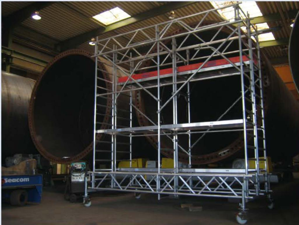
Arbeitsgerüst fahrbar inkl. Haltevorrichtung zur Versetzung des Gerüstes mittels Kran
