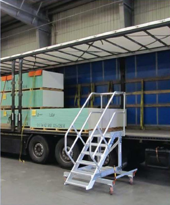
Zugangstreppe fahrbar mit Zentralbremse und Sicherungsschranke, stirnseitig auskragende Plattform
