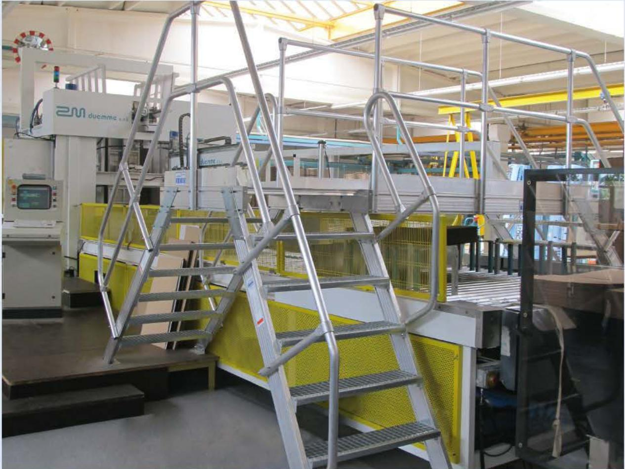
T-förmiger Übergang, stationär befestigt
