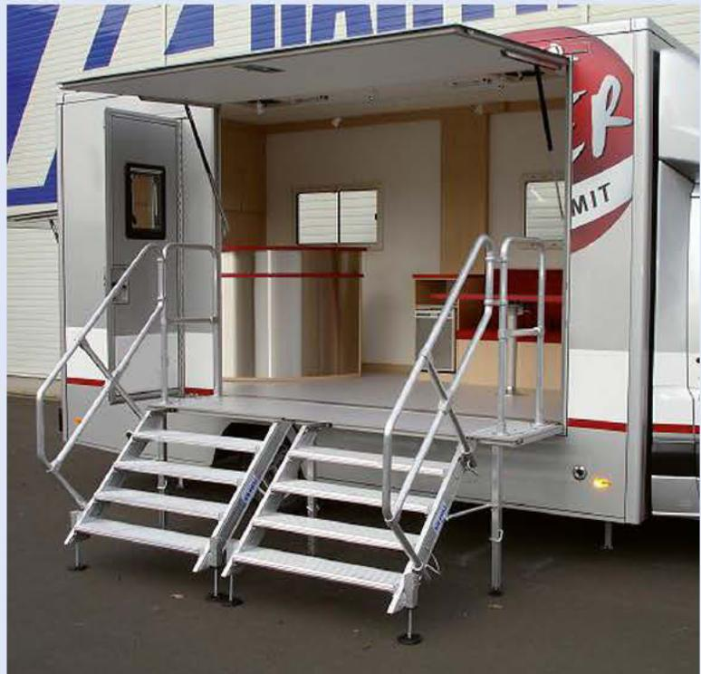
Zugangstreppe, stationäre Befestigung inkl. höhenverstellbarer Tellerfüße, Handläufe steckbar
