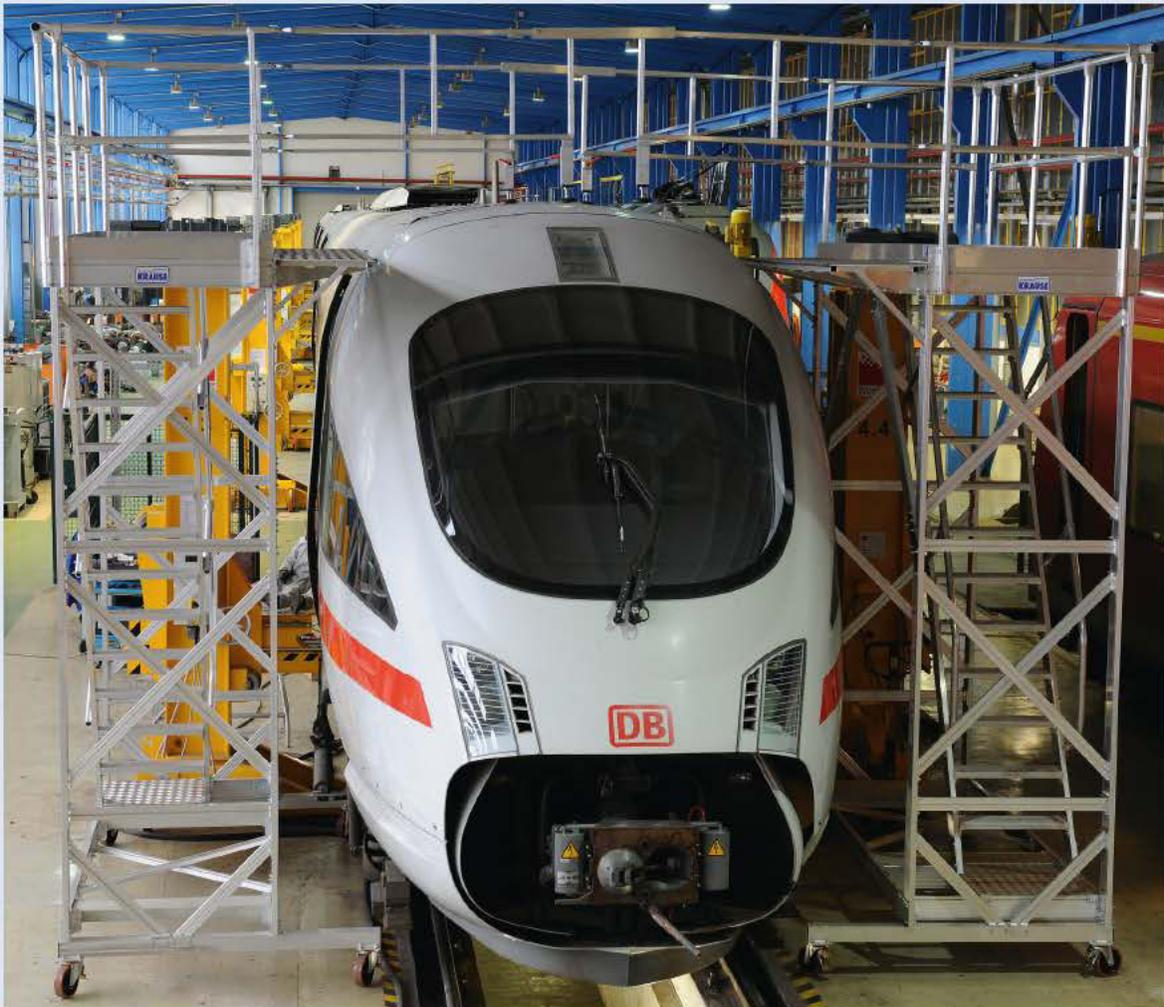
Montagebühne fahrbar mit innenliegendem Treppenaufgang, klappbares Geländer zur Verbindung zweier Montagebühnen
