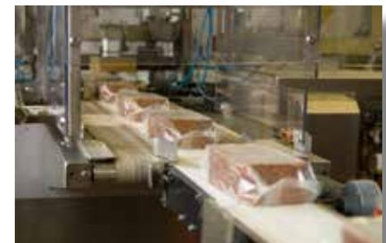
Das Brot wird luftdicht in einem Folienbeutel pasteurisiert und ist danach ungeöffnet etwa sechs Monate genußfrisch.
