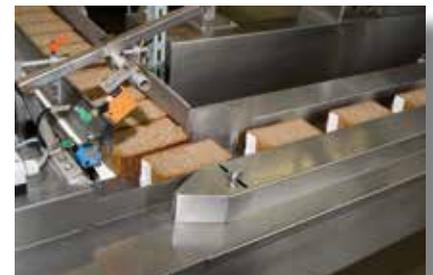
Die fertigen Brote werden nach dem Abkühlen in Scheiben geschnitten und automatisch zur Verpackungsmaschine geschoben.
