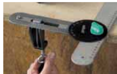
am Tisch oder Werkstück festschraubbar
