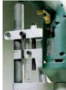
Bohrtiefeinstellung durch Tiefenstopp
