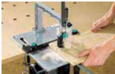
Präzision - kein seitliches Auswandern des Sägeblattes
