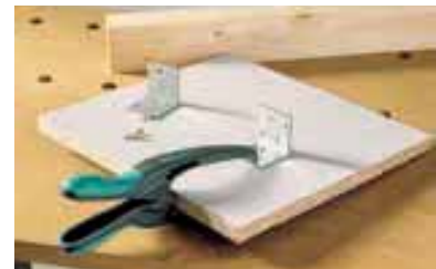
große Spanntiefe erlaubt auch Fixieren in randfernen Bereichen
