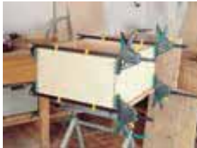
verschiebbare Abstandshalter schonen das Werkstück und dienen als Auflage
