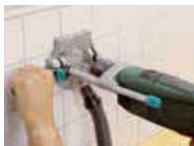
Zusatzhandgriff für punktgenaues Ansetzen und gegen Verrutschen beim Bohren
