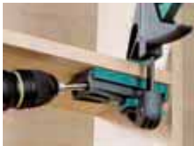
Mit dem Undercover Jig bohren Sie präzise Löcher in das Werkstück...
