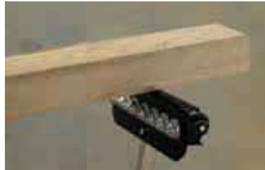
die feste Auflage dient als Verlängerung der Auflagefläche eines Arbeitstisches und als Abstützung von langen Werkstücken
