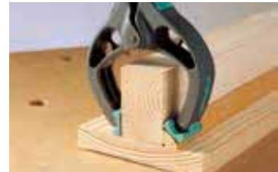
bewegliche Spannbacken passen sich dem Werkstück an
