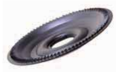
in einem Arbeitsgang wird durch den Lochrandsenker eine Randvertiefung für die plane Montage von Hohlwanddosen erstellt
